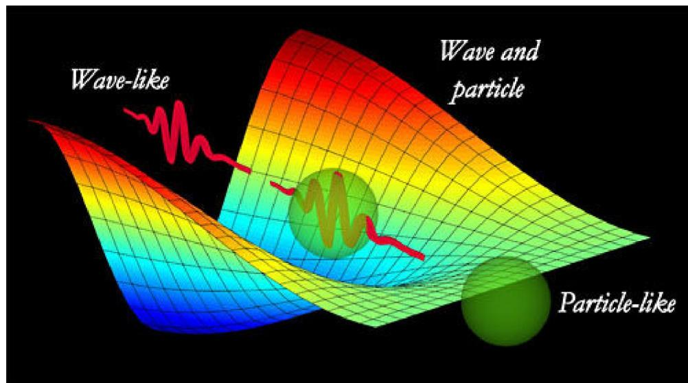
上面的想象图演示的是单光子穿过干涉仪时的情景，干涉仪的输出端装有量子分光镜。图中远处可以看到正弦振荡的波形，表示的是单光子干涉，是一种波动现象。而在图片近处，观察不到振荡，说明只表现出粒子的特性。在两种极端之间，单光子的行为连续不断地从波的形式向粒子形式转变，图中显示了这两种状态的重叠。
