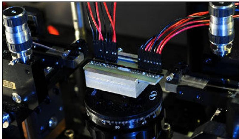
实验中用以检测波粒二象性的量子光子芯片。单光子通过光纤进入环路，在输出端被极其敏感的探测器检测到。
